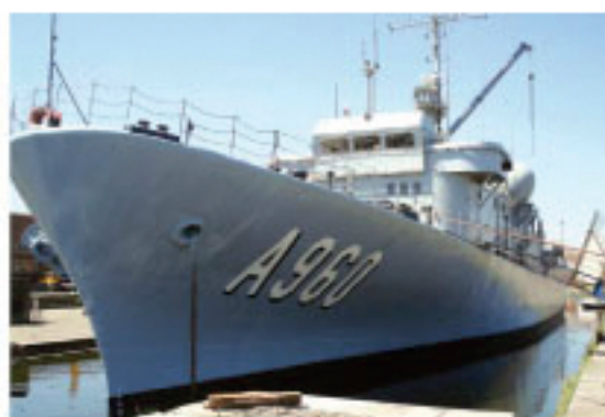
Depuis l'application du revêtement Ecospeed en 2004, la coque du Godetia est toujours en excellent état.
